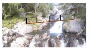
3ème FRANCHISSEMENT: ancrage des supports directement dans la roche sur berges (nécessite expertise géotechnique) – optimisation du cout – pas de plot béton et pose d'un pont népalais structure légère avec platelage bois sur câble : replis possible pour l'hiver.
