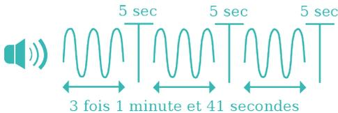
Quand il s'agit d'un essai, la séquence retentit une seule fois et ne dure donc qu'1 min et 41 sec.
